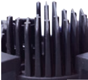
Abbildung zeigt „Kühlrippen“ eines LED-Scheinwerfers
