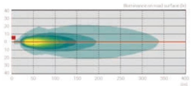
Isolux Diagramm ECE NCC® ARTON Fernscheinwerfer „Competition“, mit 3 LEDs
