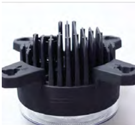
Abbildung zeigt „Kühlrippen“ eines LED-Scheinwerfers
